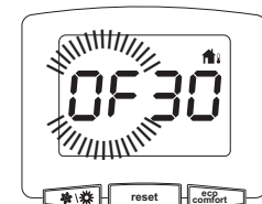
fig. 11 - Desplazamiento paralelo de las curvas
